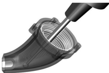
Рис. 11. CAM-симуляция процесса обработки детали на пятикоординатном фрезерном станке с числовым программным обеспечением Источник: (Siemens PLM, 2021).
