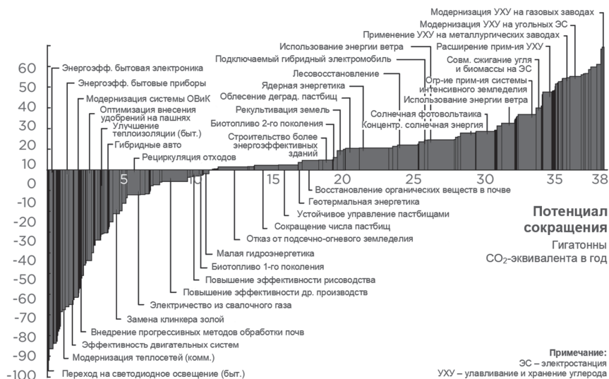
Рис. 1. Кривая затрат по сокращению выбросов парниковых газов (евро за тонну CO 2 -эквивалента)
